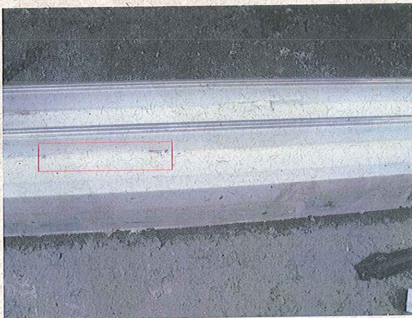
Foto nº. 02 Verificação da estanqueidade à água: Aplicação de silicone no dreno do perfil intermediário, vedando a unidade.
